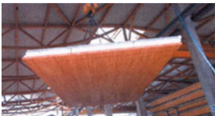
Fig. 2 – Movimentazione di un pannello Wood Beton Evoluzione.
