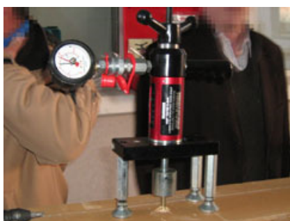
Misurazione della forza di serraggio dei supporti delle Linee-Vita con chiave dinamometrica.
