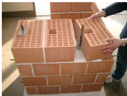
Campione di muretto realizzato con il "nuovo" blocco.
