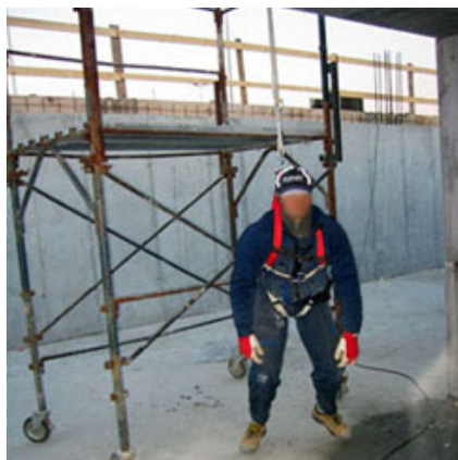
Fig. 16 - Operatore sospeso durante la simulazione di caduta. Per esigenze della sperimentazione, il cordino della simulazione è di lunghezza maggiore a quello in dotazione agli operatori. La luce libera tra i piedi dell'operatore e il suolo deve essere aumentata di circa 50 cm.
