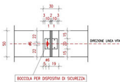
Fig. 4 - Particolare di progettazione della trave TLQ con inserimento della boccola di Rurefast.
