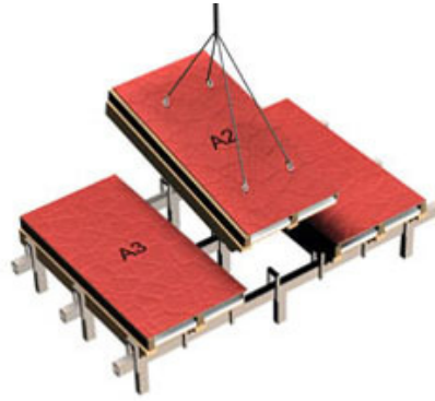
Fig. 3 - Fase di scasso e di movimentazione dei pannelli Preconnect.
